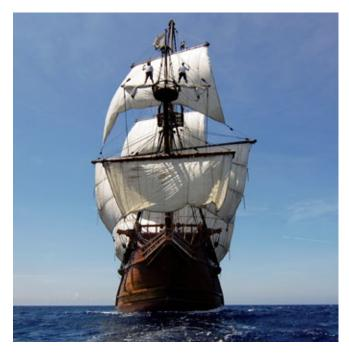
la construcción del galeón, que necesitó de 17 meses y el trabajo de 150 personas hasta su botadura, dejándolo listo para navegar en Febrero de 2010. En su fabricación se utilizaron técnicas novedosas, tales como fabricar el casco y las cubiertas con sistemas constructivos a base de fibra de vidrio y recubrir la estructura, cubiertas y casco con madera de pino e iroko. Por primera vez se ha empleado esta técnica en barcos mayores de 500 toneladas destinados a navegaciones oceánicas.
